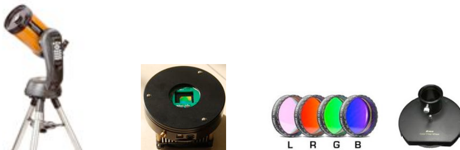
Fotografía 3: Instrumental para la realización de medidas de la contaminación lumínica con fotometría estelar Telescopio (izda.), cámara CCD (centro), juego y rueda de filtros (dcha.)
